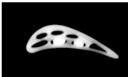
图 5 测试件位置 1 处的 CT 图像
