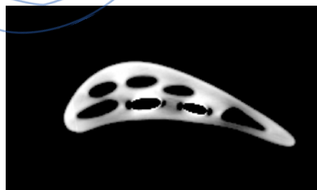
图 11 去除多余物的叶片 CT 图像
