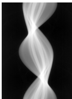
图 8 标准件位置 1 处扫描得到的正弦图
